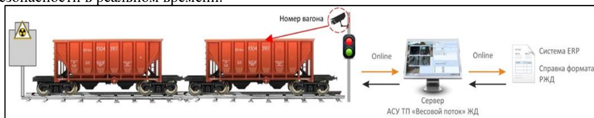
Рисунок 1 – Автоматизация распознавания номеров вагонов
