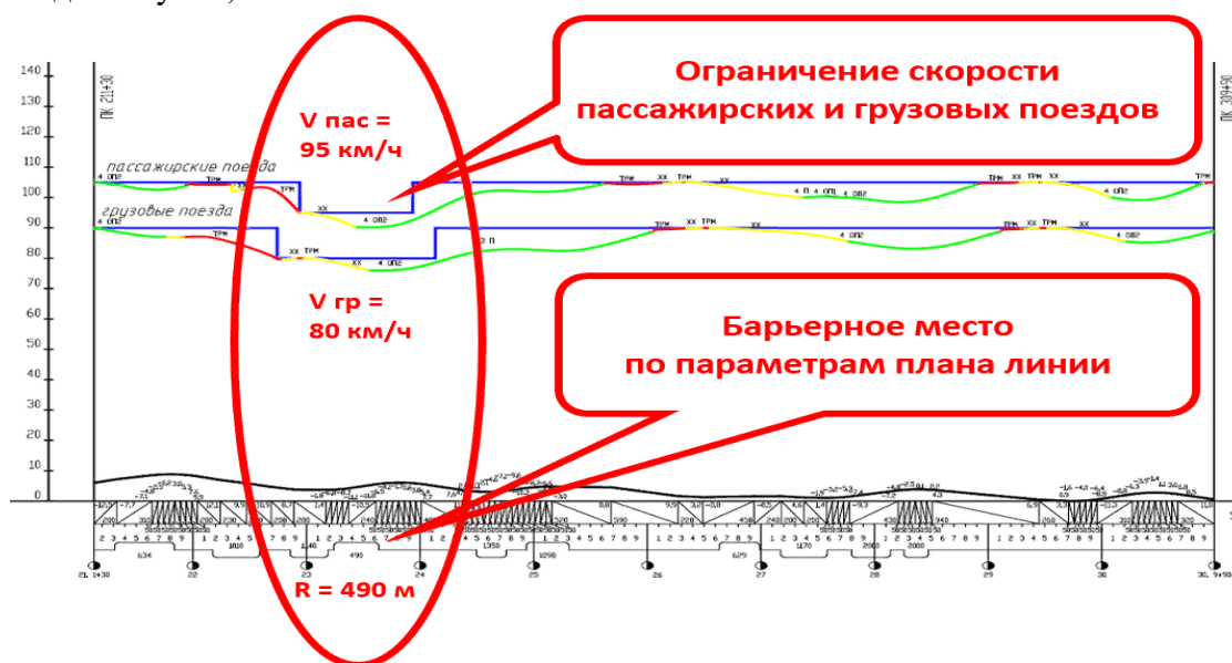
Рисунок 1 – График скорости грузовых и пассажирских поездов в четном направлении по II пути, построенные по результатам тяговых расчетов в ПК ЭРА до реконструкции
