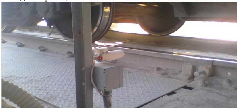
Рисунок 3 – Автоматическое считывание информации на весах
