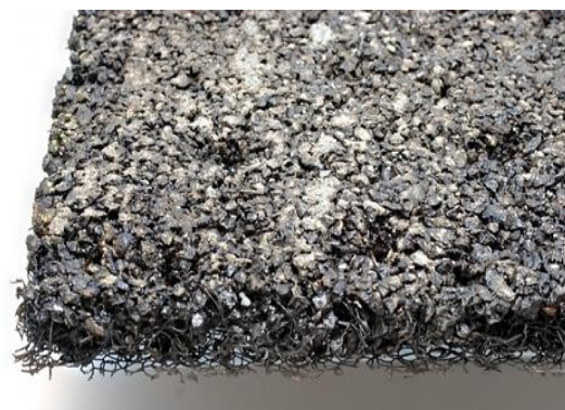
Рисунок 3 – Типы противозэрозийных геоматов: а – Энкамат7225; б –Энкамат А20
