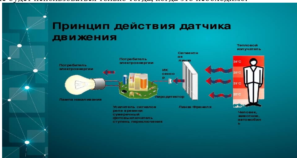
Рисунок 1– Принцип действия датчика движения.
